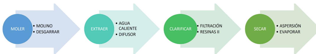
Figura 1. Proceso para la extracción de fructanos de agave. El agave se procesa crudo.
